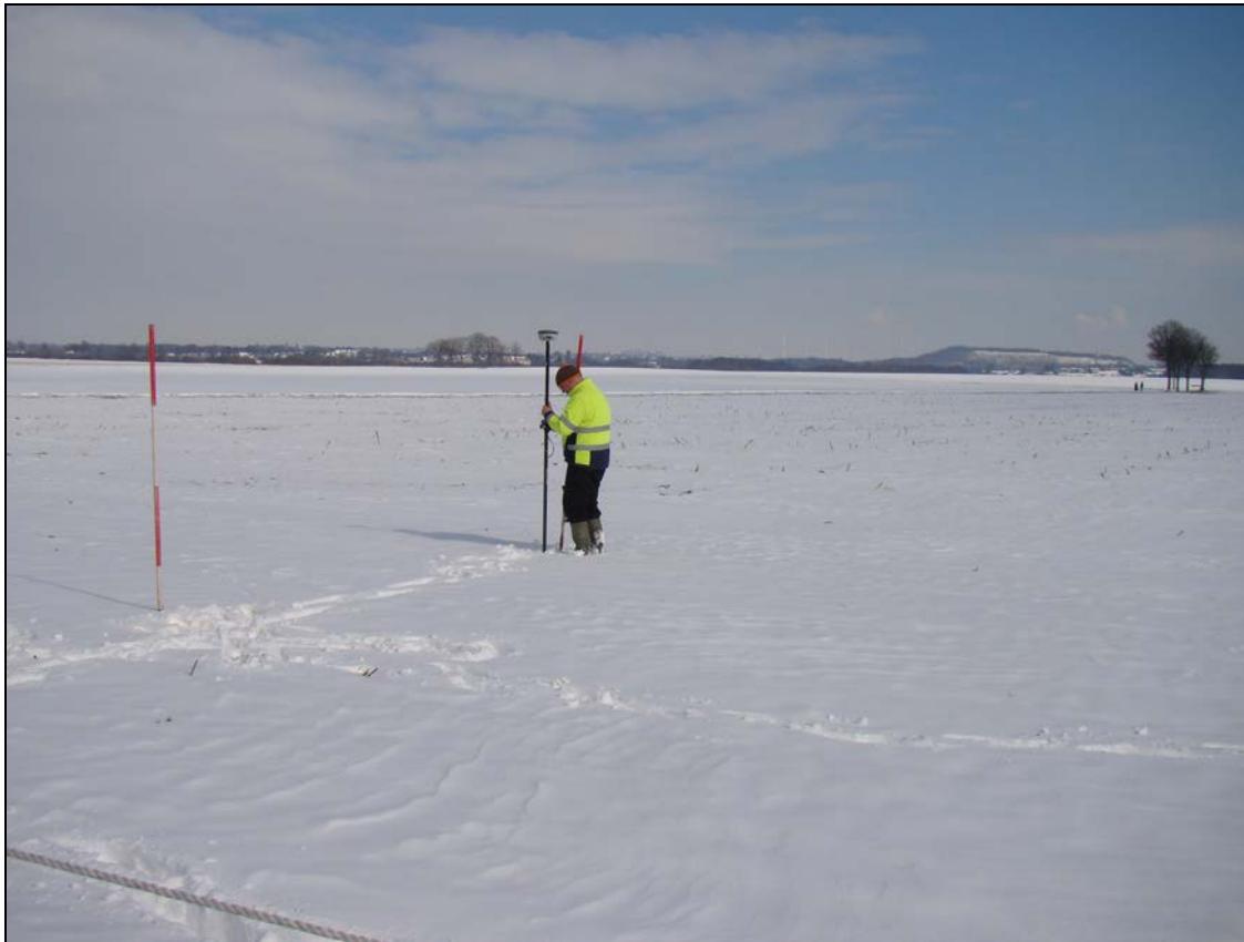
Afbeelding 8. Fotografische weergave van het uitzetten van de proefsleuven met behulp van de GPS Rover (GRX1). Fotograaf: L. R. van Wilgen.
