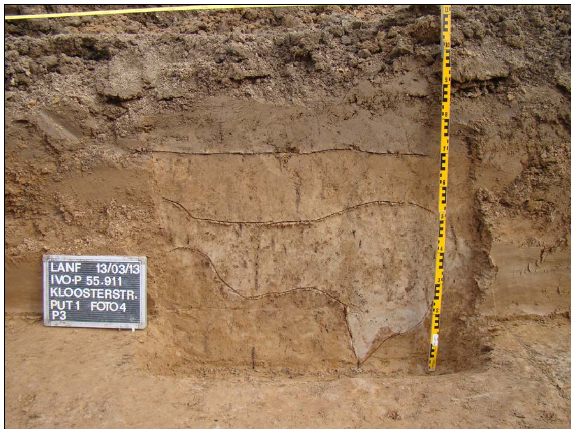
Afbeelding 17. De bodemopbouw van de bouwvoor op geroerde löss op radebrikgrond (E-horizont op Bt-Horizont), geïllustreerd aan de hand van Profiel 3 in Proefsleuf 1. Dit is de enige profielopname binnen het IVO-P, waarin een duidelijke E-horizont is waargenomen. Foto (Foto 4) genomen naar het oosten. Fotograaf: A. C. Mientjes.
